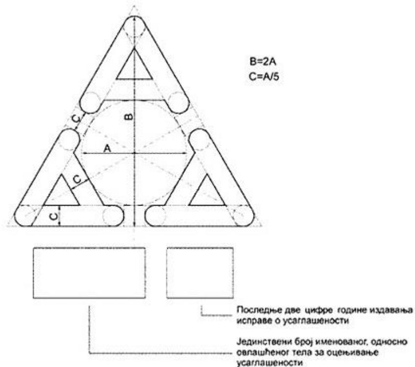
Veličina znaka određuje se prema visini V znaka koja može da ima samo zaokružene vrednosti standardnih brojeva prema redu veličina R10 izraženih u milimetrima (mm) prema srpskom standardu SRPS A.A0.001, Standardni brojevi - Redovi standardnih brojeva.
